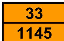
Il numero superiore **33** (NIP, numero di identificazione del pericolo) ci indica che si tratta di una materia liquida molto infiammabile con punto di infiammabilità inferiore a 23°C. La materia non è tossica o corrosiva e non reagisce pericolosamente con l'acqua.
